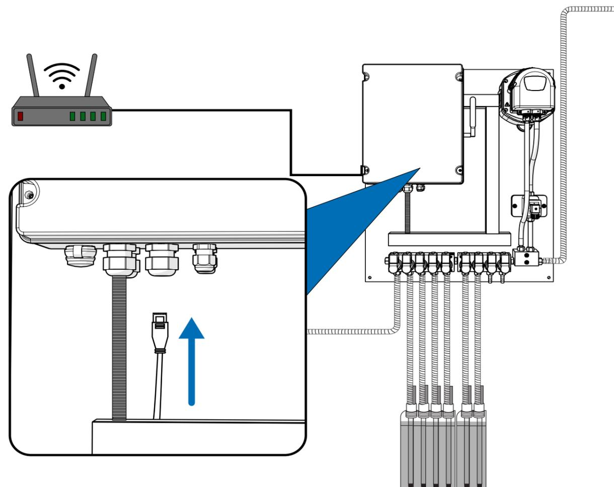
Para conectar tu Equipo a Internet, sólo tienes que enchufar un cable Ethernet a cualquier router a través del conector situado en la parte inferior de la caja principal.
