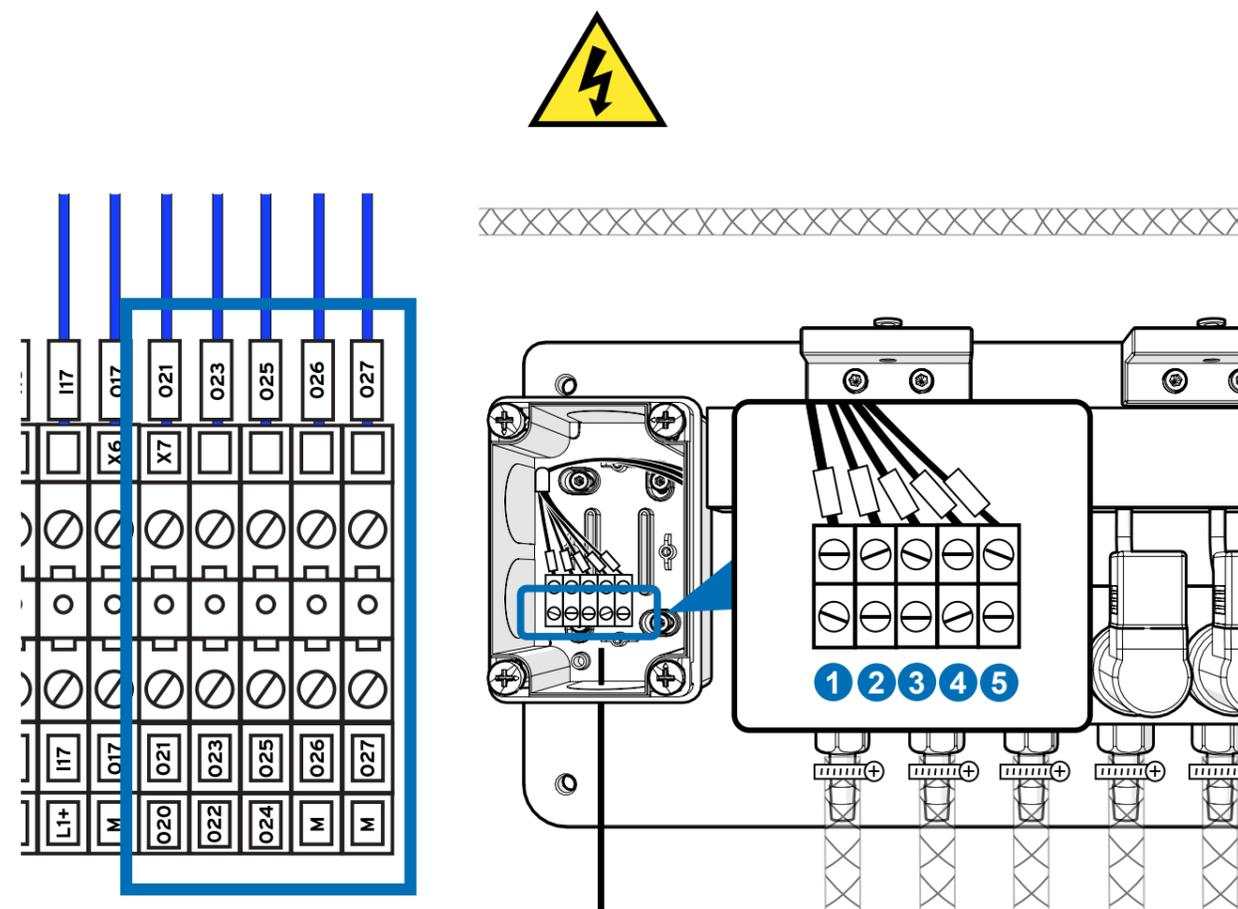
Utilice un cable de 7x1mm<sup>2</sup> para la conexión entre la cabina de control y el distribuidor. Conecte el distribuidor al bloque de terminales X7. Cada conexión de terminal corresponde a las salidas numeradas de izquierda a derecha, dependiendo el número del orden. A continuación se muestra el esquema eléctrico del Equipo principal.
