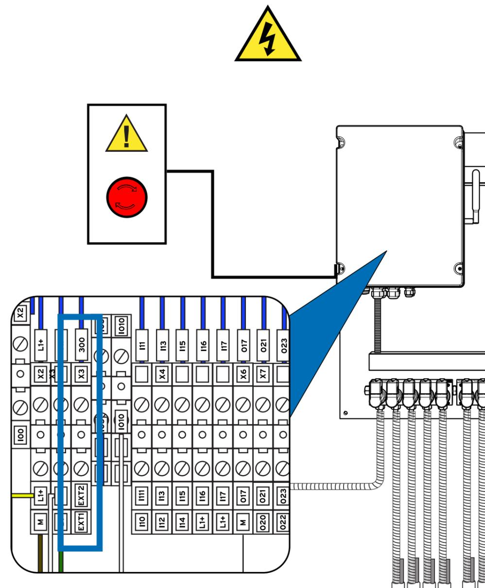
Para conectar un botón de parada de emergencia a su Equipo, puede utilizar la ranura para conectores EXT1 y EXT2 que se muestra arriba en serie.
