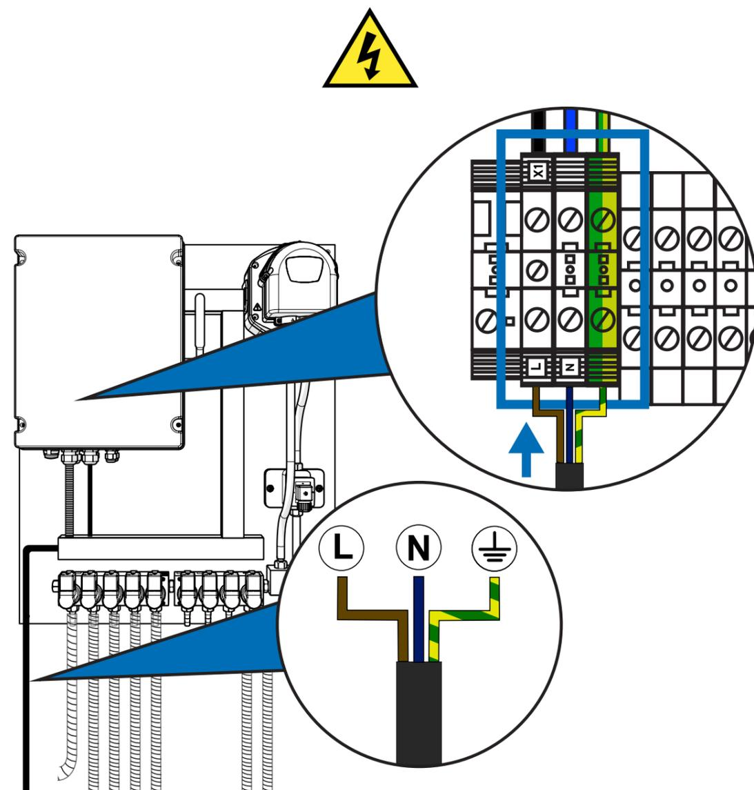
Para la alimentación del equipo debe utilizar cable de 3x1'5mm<sup>2</sup>. Introduzca el cable por el canal situado en la parte inferior izquierda y utilice uno de los prensaestopas para introducirlo de forma segura en el interior del armario eléctrico. Conéctelo a los bornes identificados con X1 que se encuentran en la parte inferior izquierda de las conexiones.
