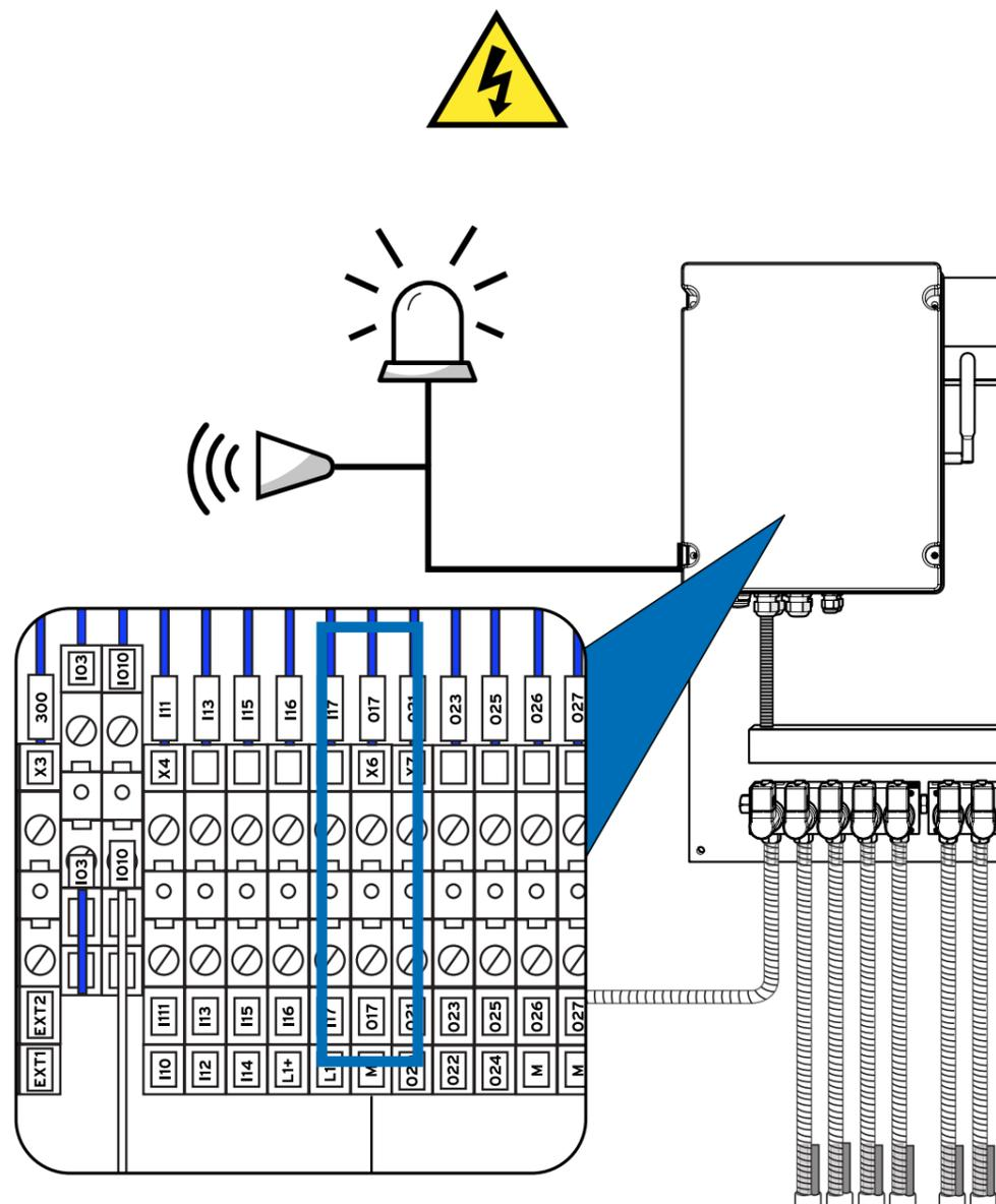
Para conectar una alarma externa o una luz de advertencia al sistema, utilice la ranura X6 como se muestra arriba.
