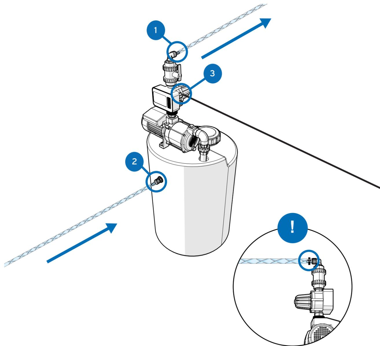
Tenga en cuenta que la unidad requiere un caudal mínimo de 2 l/min y máximo de 10 l/min, así como un intervalo de presión dinámica de 1,5 bar (mínimo) a 3 bar (máximo). Se recomienda utilizar un depósito de refuerzo cuando no se disponga de un suministro de agua constante.
