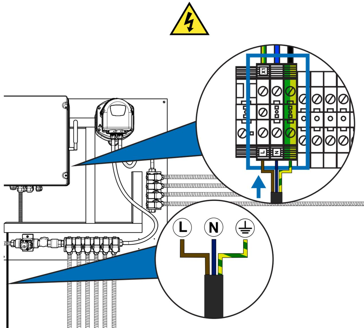
Für die Stromversorgung des Geräts müssen Sie **3x1'5mm<sup>2</sup> Kabel verwenden**. Führen Sie das Kabel durch den Kanal unten links und verwenden Sie eine der Kabelverschraubungen, um es sicher in den Schaltschrank einzuführen. Schließen Sie es an die mit X1 gekennzeichneten Klemmen links unten an den Anschlüssen an.
