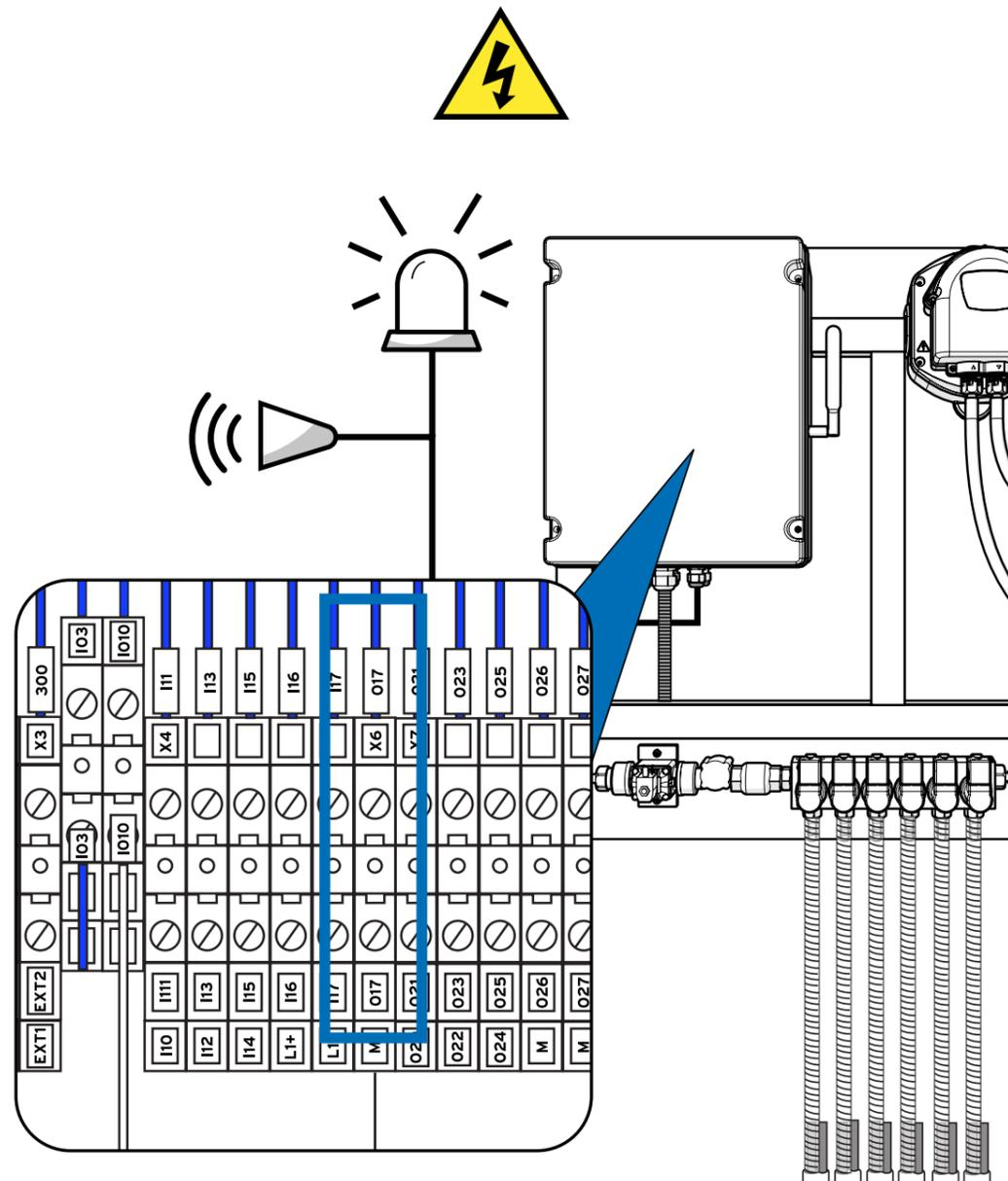
Um einen externen Alarm oder eine Warnleuchte an das System anzuschließen, verwenden Sie den Steckplatz X6 wie oben abgebildet.
