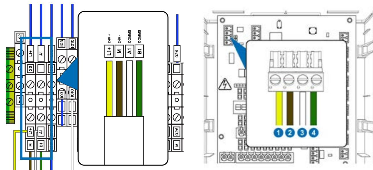
Um die externe Kommunikationsbox an das Gerät anzuschließen, verbinden Sie den Anschluss **X2** an der Hauptmaschine mit dem Anschluss **X1** an der Kommunikationsbox.
