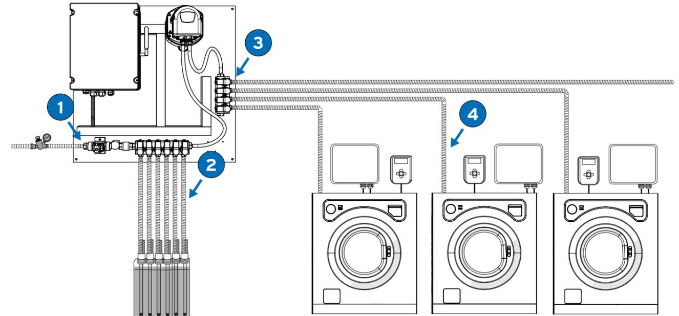
Für den Anschluss der Geräte, des Verteilers und der Unterlegscheiben sind PVC-Rohre mit 10x16 Maschen und Edelstahlschellen zu verwenden.
