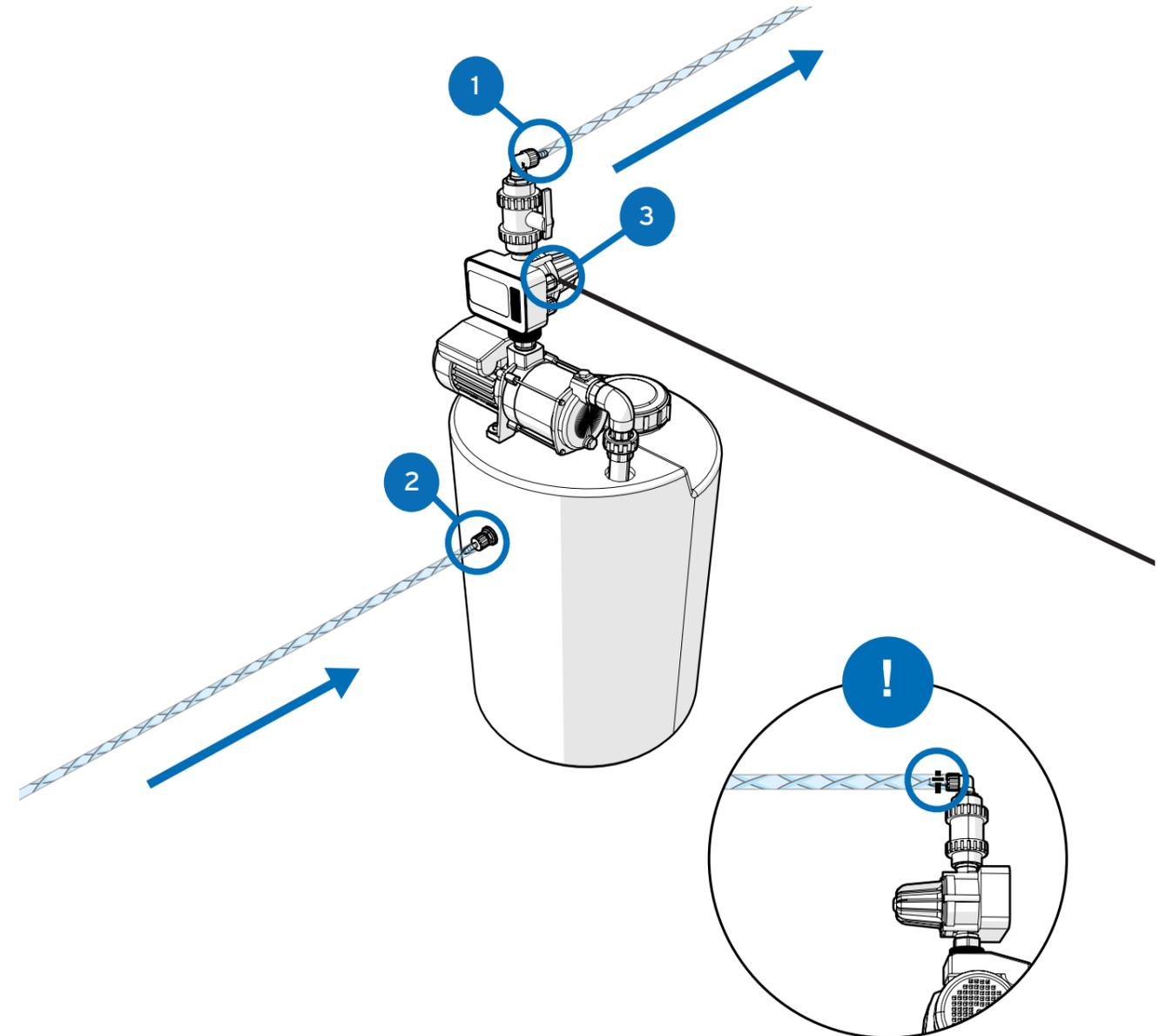
Bitte beachten Sie, dass das Gerät einen Durchfluss von **min. 2/l pro min - max. 10/l pro min** und einen dynamischen Druckbereich von **1,5 bar (min.) - bis 3 bar (max.)** benötigt. Eine Druckerhöhungsanlage wird immer dann empfohlen, wenn keine gleichmäßige Versorgung vorhanden ist.
