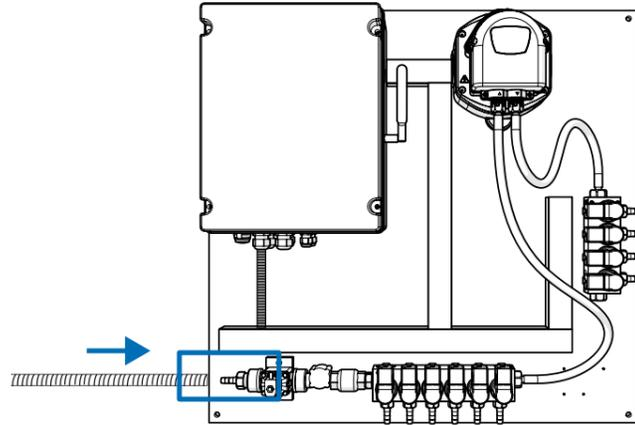
Schließen Sie die Wasserversorgung an den Wasseranschluss an, der hier am Gerät zu sehen ist. Verwenden Sie ein **PVC-Rohr mit 10x16 Maschen** und eine Schelle aus rostfreiem Stahl.
